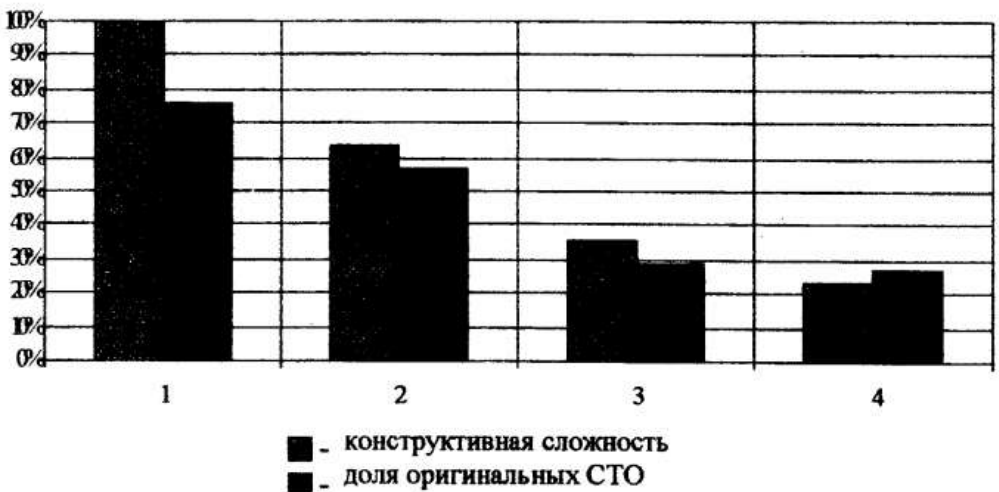
Рисунок 1 - Соотношение степени конструктивной сложности продукции и доли оригинальных СТО в общем объеме оснастки: 1- энергоустановки и системы; 2-насосные установки и турбокомпрессоры; 3-электронасосные агрегаты; 4-запасные части и блоки
