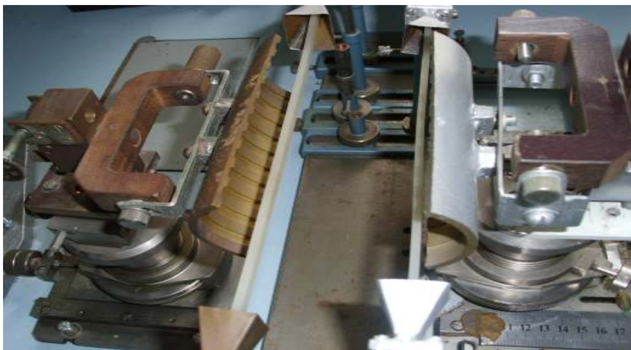
Рис. 2.5. Общий вид объекта исследований (открытого волновода) 8-миллиметрового диапазона длин волн
