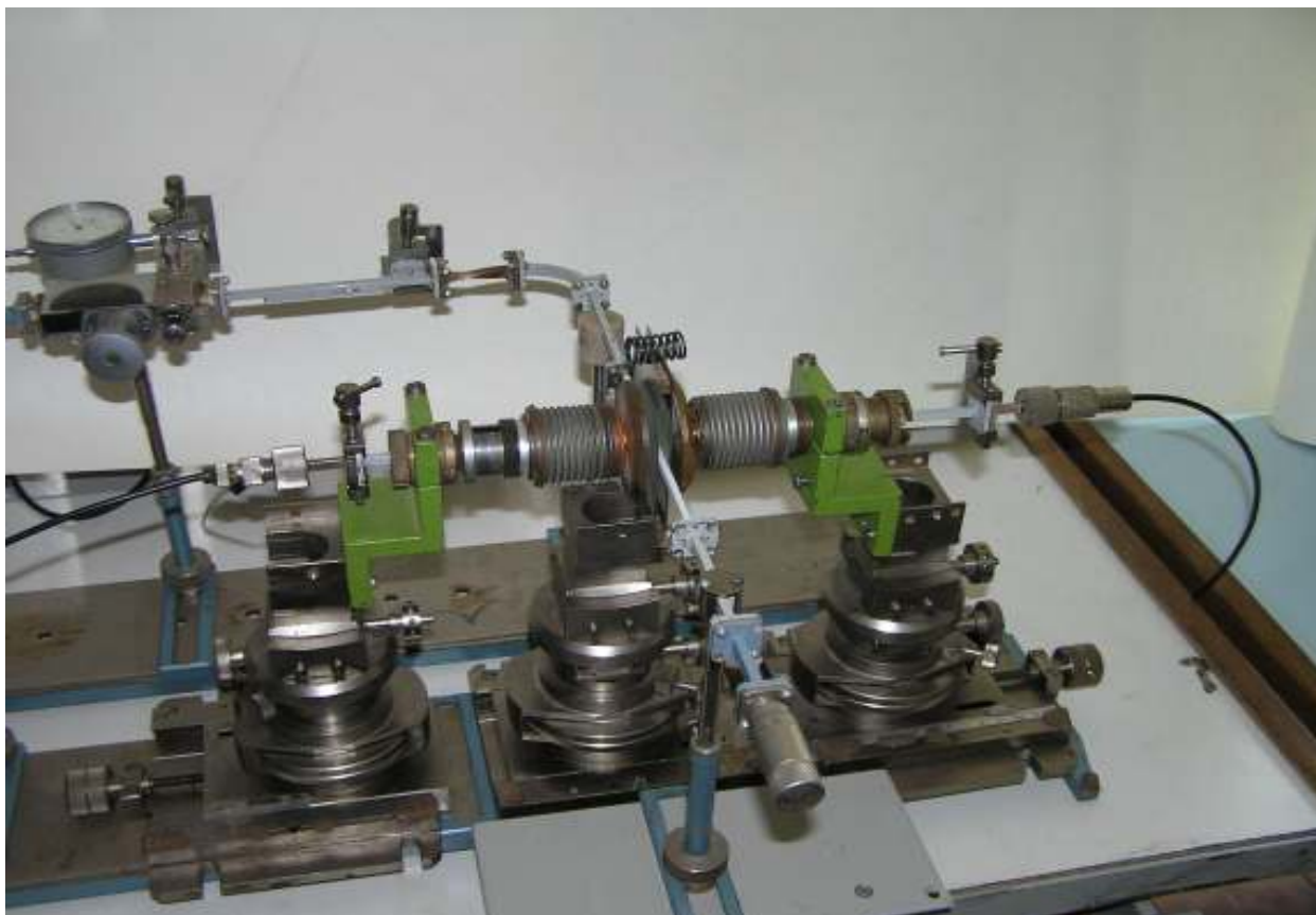
Рис. 2.4. Общий вид объекта исследования (открытого резонатора) с волноводными элементами 4-х миллиметрового диапазона длин волн
