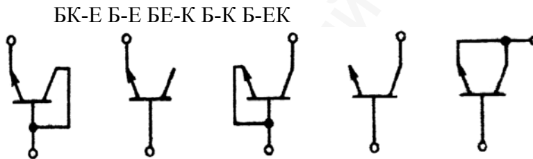
Рисунок 3.14 - Варіанти використання транзисторів у діодному ввімкненні
