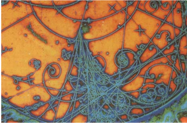
Рисунок 51 - Траєкторії (треки) та взаємодії суб'ядерних частинок, прискорених прискорювачем, що реєструються камерою Вільсона
