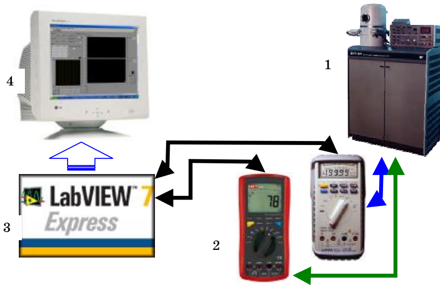
Рисунок 2.1 - Блок-схема комп'ютерної системи реєстрування та оброблення результатів вимірювання електричного опору: 1 – вакуумна камера; 2 – прилади для вимірювання опору; 3 – програмне забезпечення; 4 – дисплей комп'ютера
