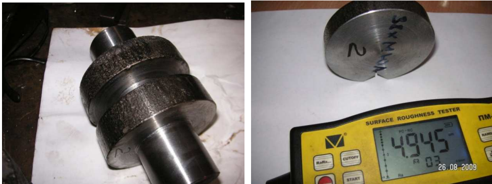
Рисунок 1 – Стальные образцы для исследования результатов ЦЭЛ
