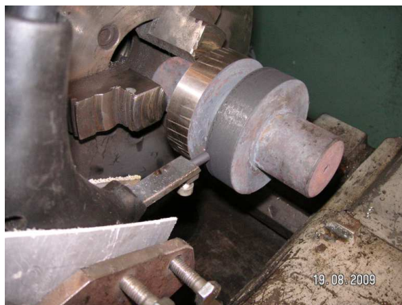
Рисунок 2 – ЦЭЭЛ с использованием токарного станка
