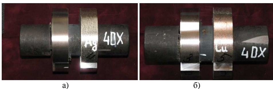
Рисунок 10 - Стальные образцы для исследования результатов ЦЭЭЛ и ЭЭЛ: а) – серебром и б) – медью
