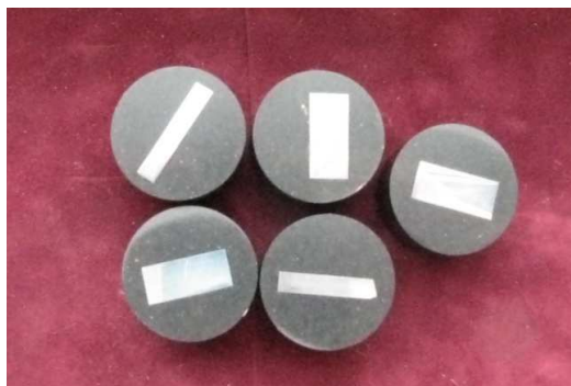
Рисунок 11 - Шлифы для проведения металлографических и дюрOMETрических исследований
