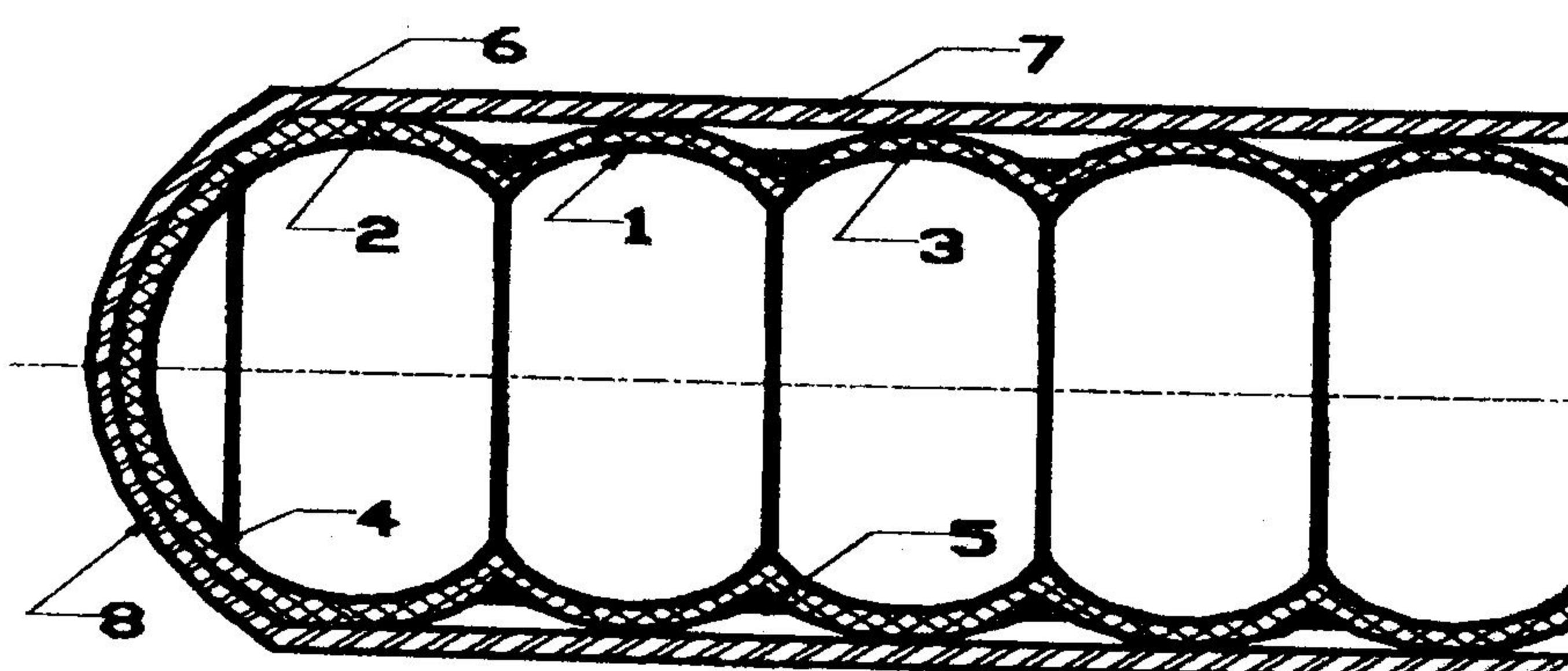
Комбинированный баллон давления содержит внутреннюю полимерную оболочку 1, несущую стеклопластиковую оболочку 2, цилиндрическая часть которой выполнена в виде набора торoidalных сегментов 3. В торцевых участках несущей стеклопластиковой оболоч-
