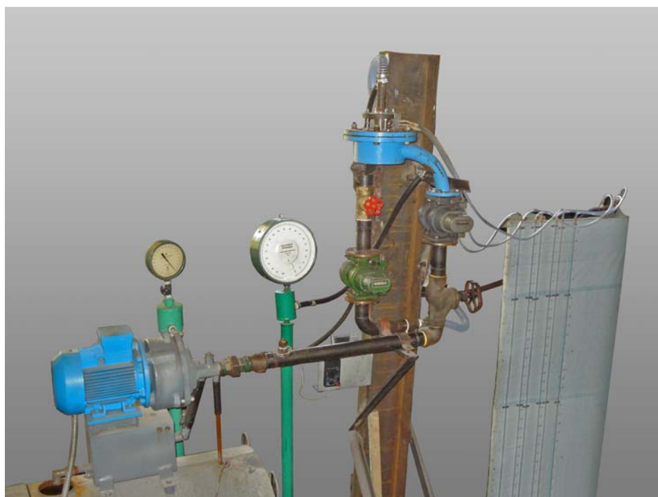
Рисунок 3.2.4. Общий вид экспериментального стенда с предвключенной вихревой эжекторной ступенью
