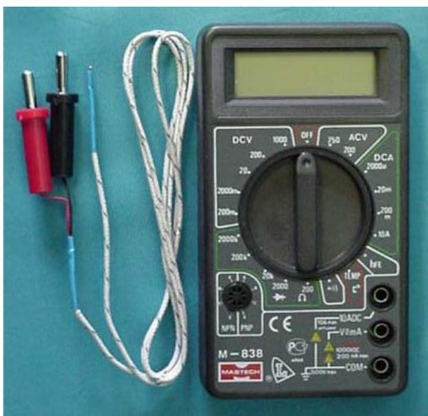
Рис. 4.4. Цифровой мультиметр Mastech M-838 и термопара TP-01A
