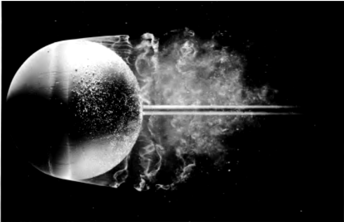
Рисунок 2.4 – Обтекание шара при Re=15000
