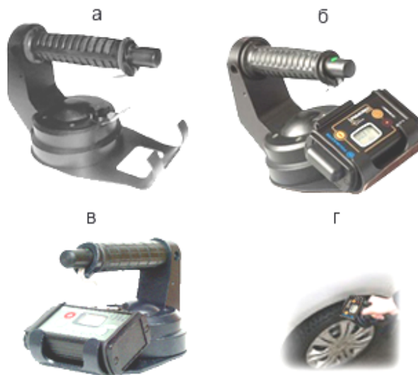
Рисунок 4 – Детекторы контрабанды: УПН-PM1401М-П Устройство поиска неоднородностей (Беларусь) (а); УПН-PM1401М-П Устройство поиска неоднородностей с дозиметром ИСП-PM1401М (б); PM-1703T Прибор для обнаружения контрабанды (Польша) (в); пример применения прибора (г)
