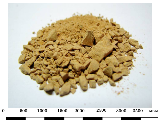
Рисунок 1 - Фото реагентного осаду (розмір частинок 0,1-50µм)
