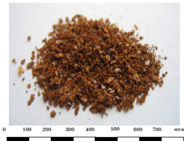
Рисунок 2 - Фото електрогенерованого осаду (розмір частинок 8-40мкм)
