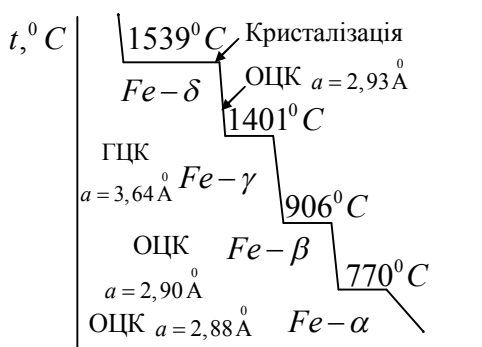
Рисунок 8.4 – Крива охолодження заліза
