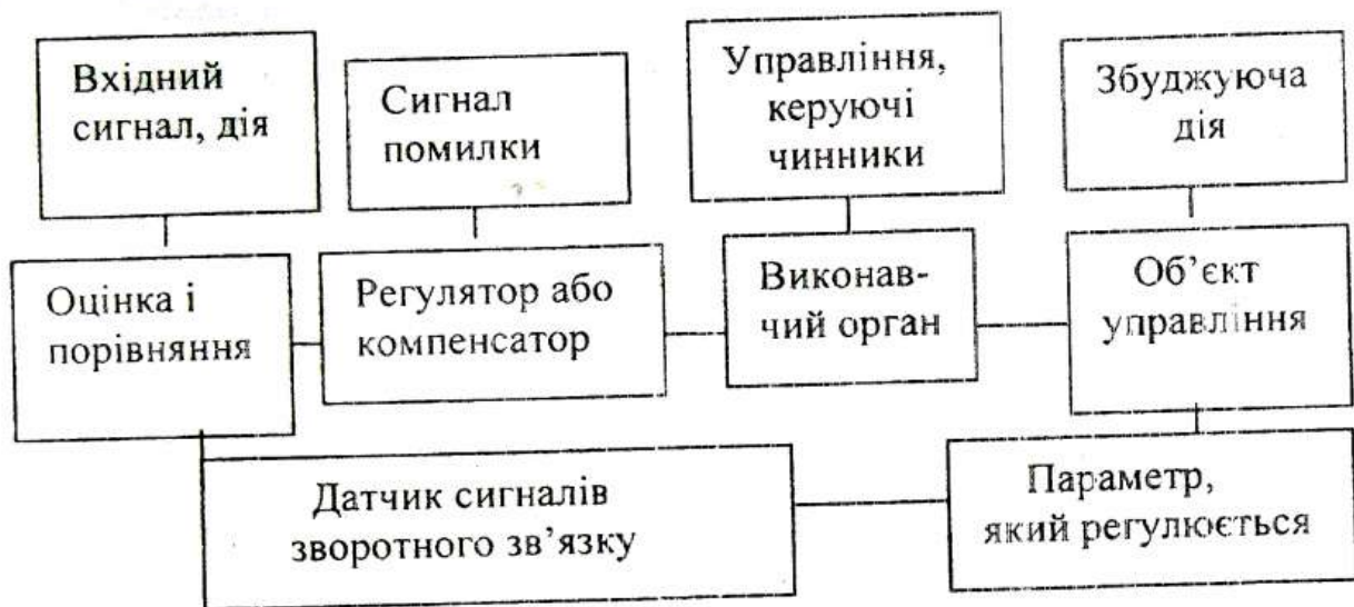
Рисунок 17.4 – Узагальнена структурна схема принципу дії механізму регулювання
