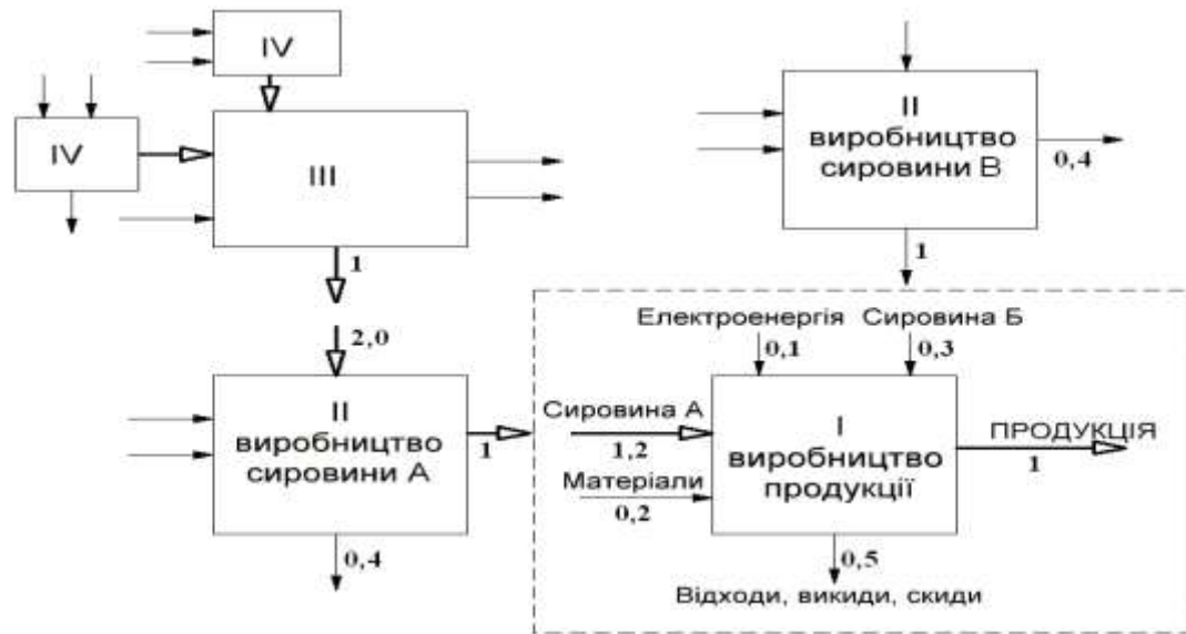
Рисунок 2.2 – Спрощена блок-схема системи виробництва продукції з визначенням рівнів підсистем
