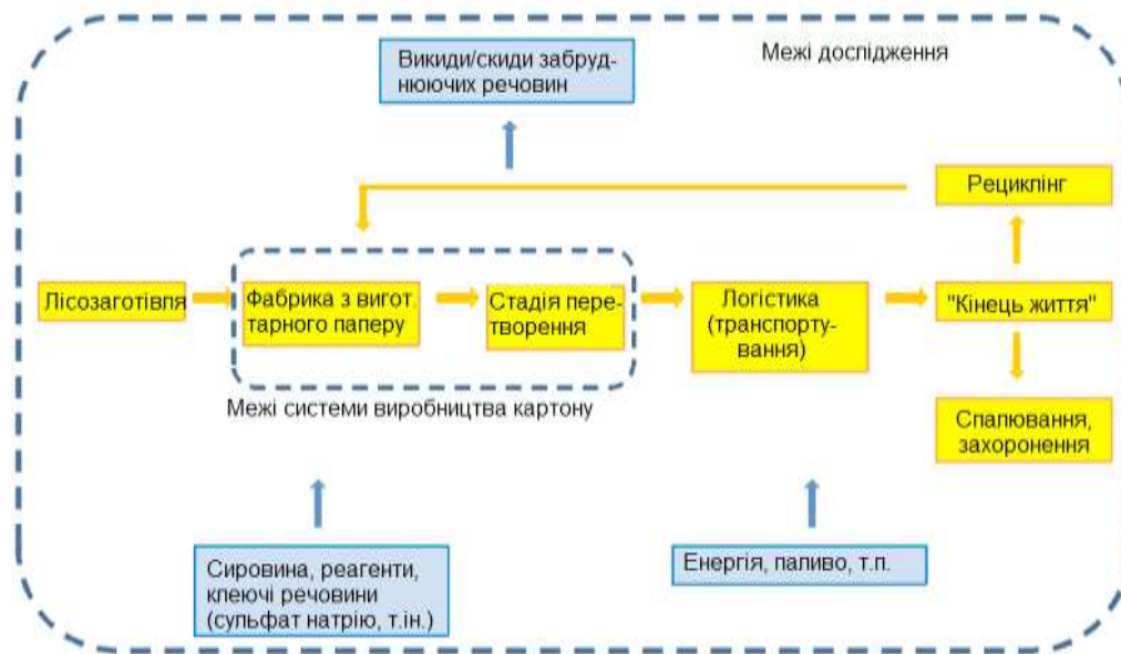
Рисунок 3.1 – Системні межі ОЖЦ і стадії життєвого циклу Функціональною одиницею є 1 тонна готової продукції.
