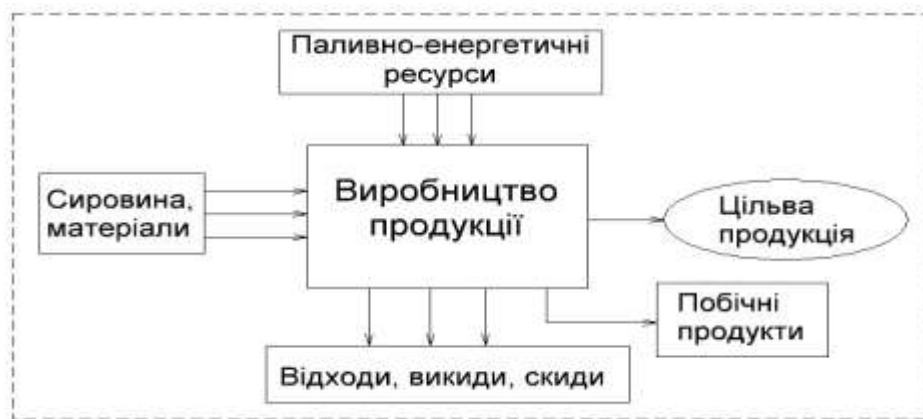
Рисунок 2.1 – Основні вхідні і вихідні потоки, характерні для стадії виробництва продукції
