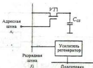
Рисунок 6.7- Простейшая схема ЗЯ накопителя динамического ОЗУ
