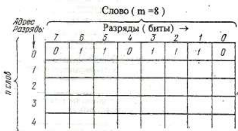
Рисунок 6.2.- ЗУ, состоящее из n слов по m бит ( n \times m )
