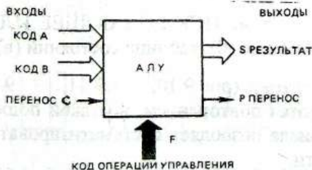
Рисунок 9.9- АЛУ, его входные и выходные сигналы
