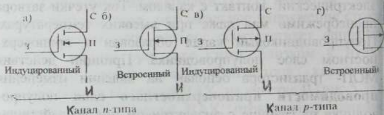
Рисунок 5.4- Схематическое изображение полупроводниковых транзисторов с изолированным затвором
