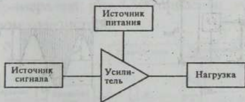
Рис. 7.1-Обобщённая схема включения усилителя
