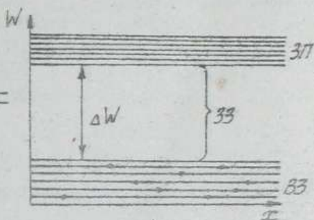
Рис. 1.2. Енергетична діаграма бездимішового напівпровідника при T=0
