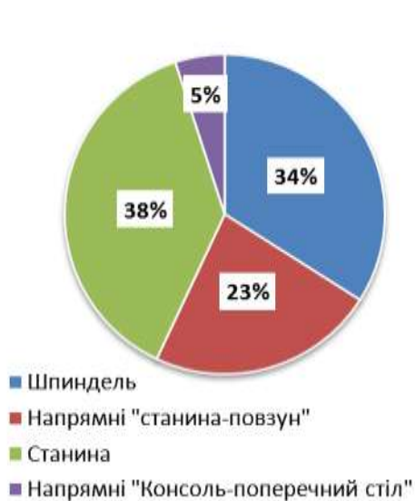
Рисунок 3.9 – Порівняння внеску переміщення елементів технологічної системи у сумарне переміщення зубів фрези у напрямі осі X
