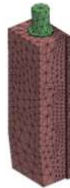
Рисунок 1.6 – Скінченноелементна модель поперечного стола верстата
