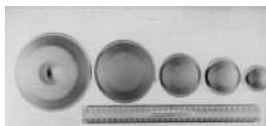
Рис.6.4. Керамічні форми для плакування ущільнювальних кілець Ø100, 80, 50, 40, 25
