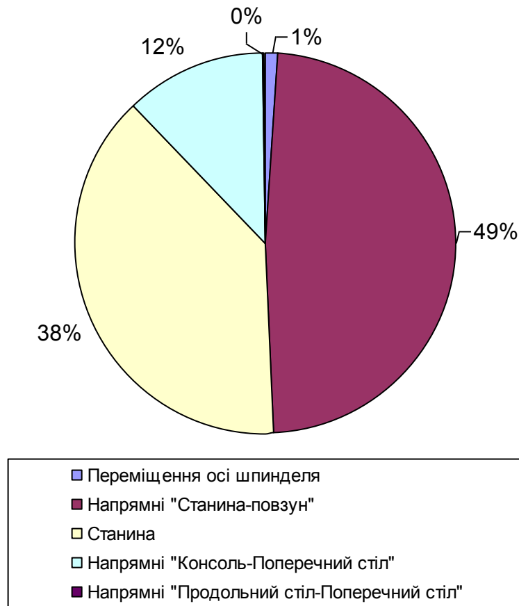
Рисунок 4.11 – Порівняння внеску переміщення елементів технологічної системи у сумарне переміщення зубів фрези у напрямі осі Y
