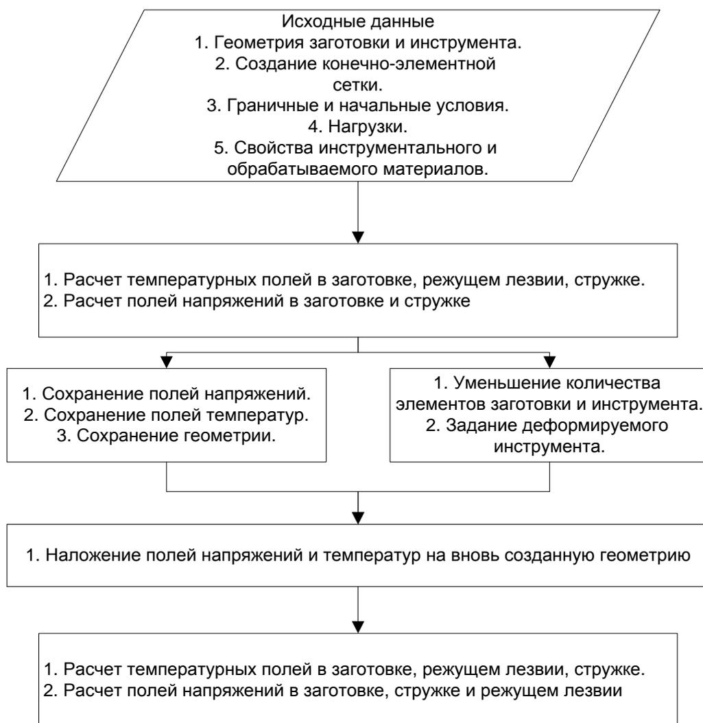
Рисунок 3.7 – Укрупненный алгоритм расчета напряжений и температур в лезвии при резании с переменной толщиной среза
