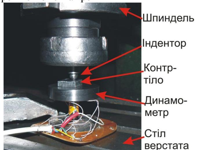
Рис. 7.6. Схема нагрузки
