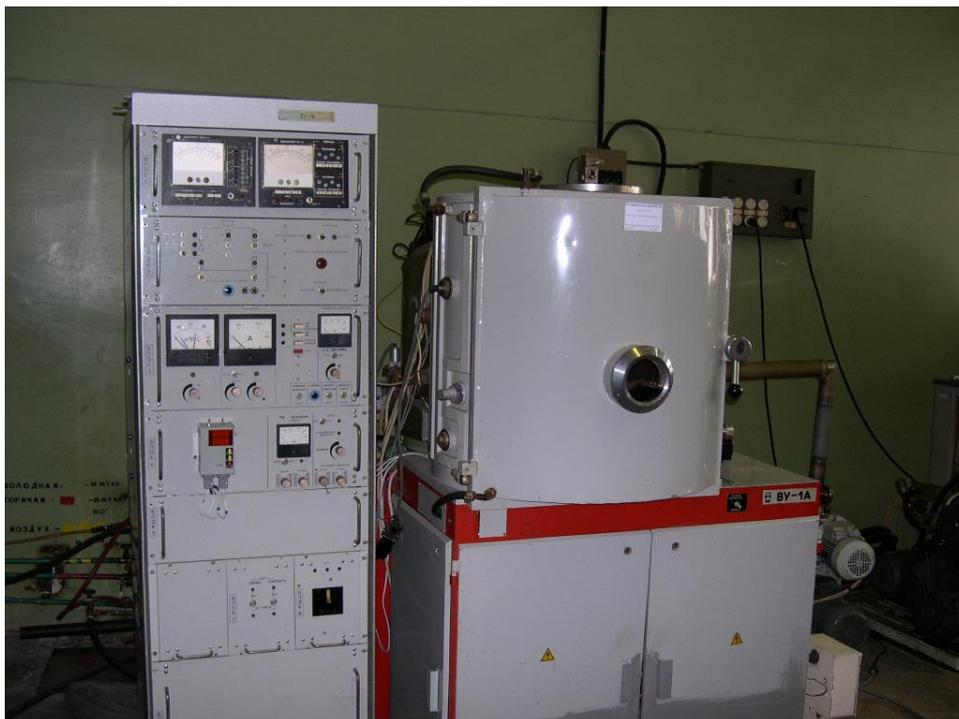
Рисунок 1.7 – Установка для ионно-лучевой обработки
