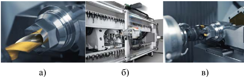
Рис. 4.3. Pick-up система фірми Chiron: а – шпиндель із інструментом; б – ланцюговий інструментальний магазин; в – заміна інструмента
