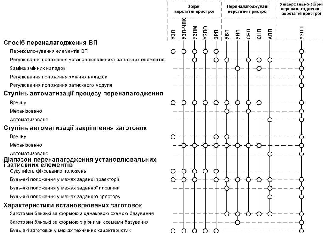
Рис. 7.2. Технічні характеристики систем верстатних пристроїв
