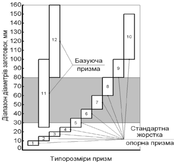
Рис. 8.16. Типорозміри базуючих модулів: 1–10 – стандартні жорсткі опорні призми; 11, 12 – запропоновані базуючі призми
