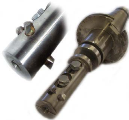
Рис. 4.41. Дворізцева розточувальна оправка
