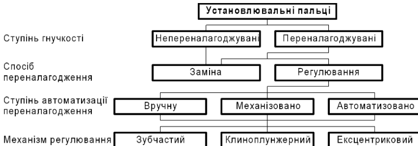
Рис. 7.16. Класифікація установлювальних пальців верстатних пристроїв
