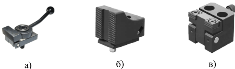
Рис. 7.18. Бокові прихоплювачі з різними механізмами регулювання: а – ексцентриковим; б – клиновим; в – гвинтовим
