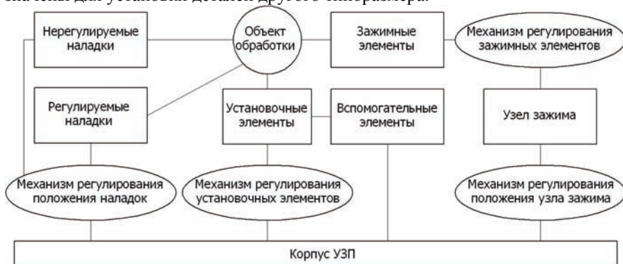
Рис. 4. Структура установочно-зажимного приспособления
