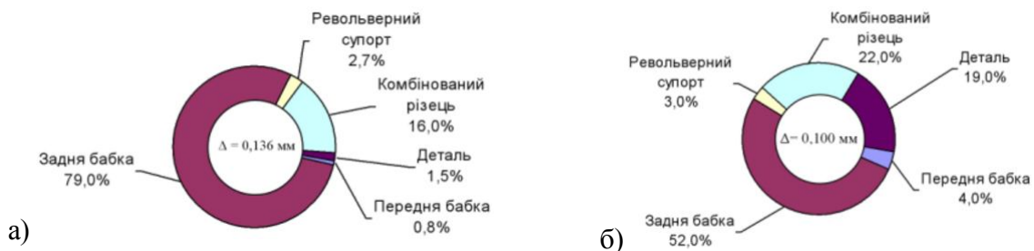
Рис. 9. Вплив пружних переміщень елементів технологічної системи на похибку обробки комбінованим різцем: d = 64 \text{ мм} ; L_B = 45 \text{ мм} ; L_P = 30 \text{ мм} ; а – L = 500 \text{ мм} ; б – L = 220 \text{ мм}
