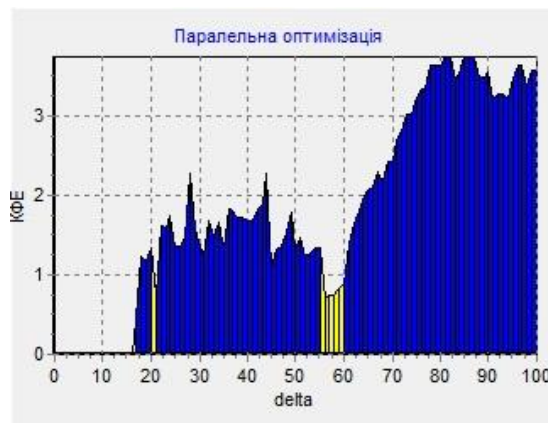
Рисунок 1 – Графік залежності КФЕ від параметра поля контрольних допусків \delta_K ( delta )
