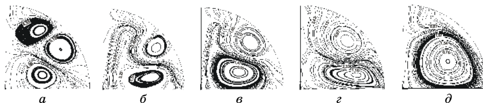
Рисунок 4 - Слияние трех циркуляций в одну при возрастании времени затухания окружной скорости течения по результатам численного моделирования при Re_0=2150 : а- T=1,57 ; б- 3,64 ; в- 7,67 ; г- 11,2 ; д- 15,3
