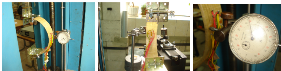
Рисунок 19 – Принцип работы устройств и оборудования, используемых при тестировании различных составных изогнутых стержней для получения модуля упругости и смещений
