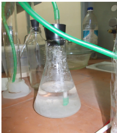
Рисунок 8 - Ацетатная ловушка с осажденным в виде сульфида цинка (белый осадок) сероводородом
