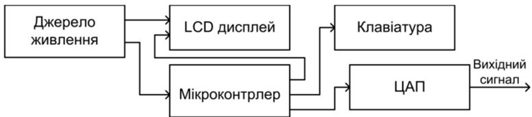
Рисунок 1 – Структурна схема DDS генератора
