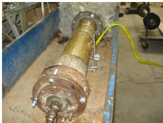
Рисунок 6 - Загальний вигляд установки для проведення гідростатичних випробувань
