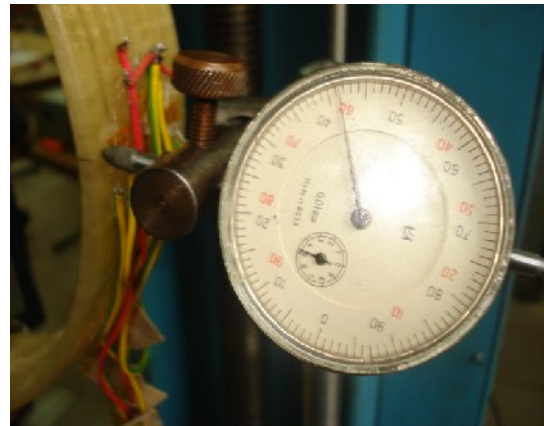
Рисунок 5 - Конструкція для випробування криволінійних брусків зі склопластику на згинання
