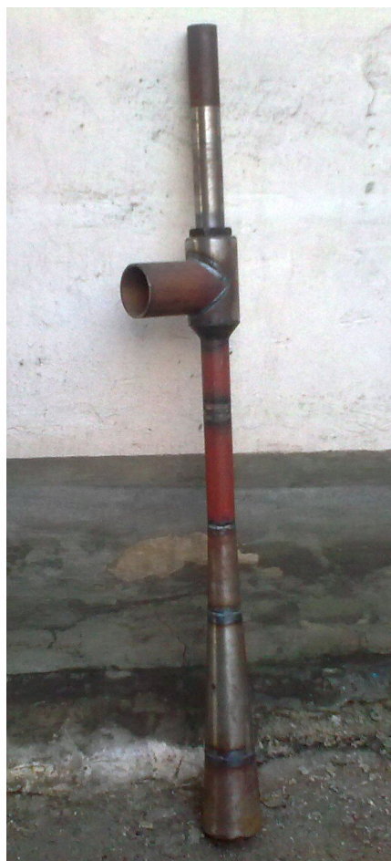
Рисунок 5.8 - Струйный аппарат эрлифта: а) – схема струйного аппарата; б) – конструктивное исполнение струйного аппарата
