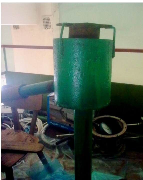
Рисунок 4.6 - Воздухоотделитель экспериментального эрлифта: а) конструктивное исполнение воздухоотделителя; б) схема воздухоотделителя
