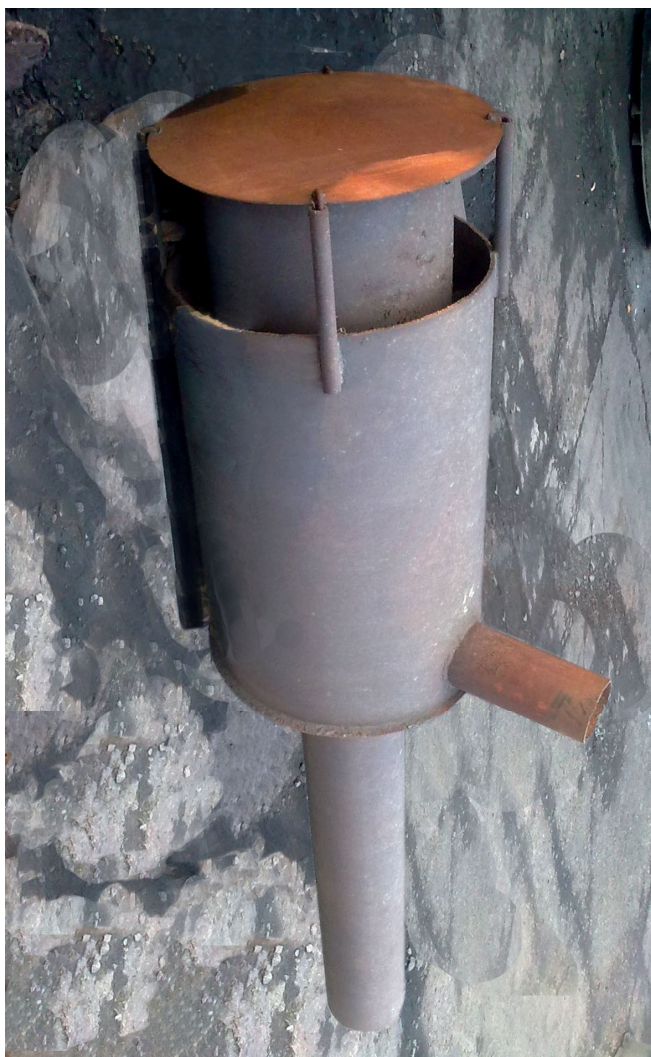
Рисунок 5.7 - Воздухоотделитель эрлифта Старобешевской ТЭС
