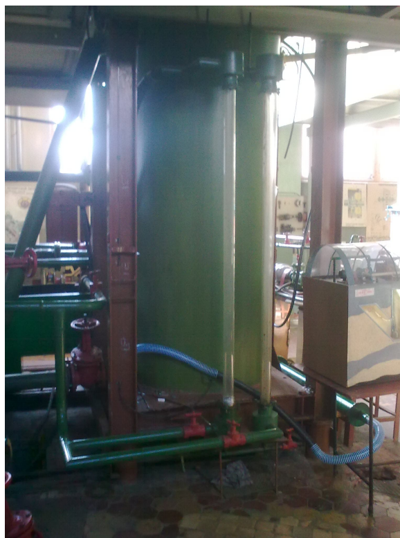
Рисунок 4.2 - Основная емкость экспериментальной эрлифтной установки
