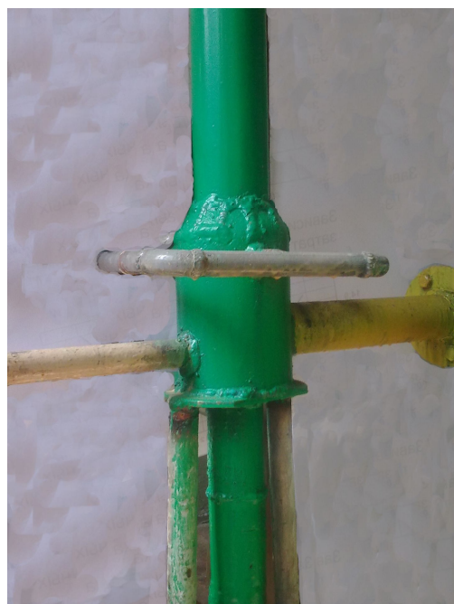
Рисунок 4.2 - Основная емкость экспериментальной эрлифтной установки
