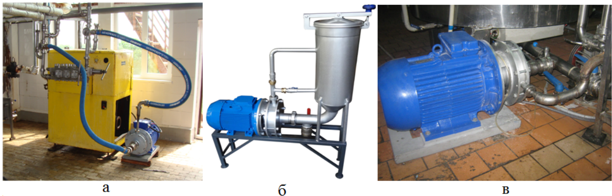
Рисунок 18 – Фото промислових зразків багатофункціонального ГАГ а – ГАГ-30 поряд з плунжерним гомогенізатором (55 кВт), б – лабораторна установка для виготовлення наномодифікованих гідросумішей, в – багатофункціональний ГАГ-22 замінивший технологічну лінію виготовлення згущеного молока
