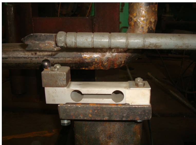
Рисунок 3.3 – Механізм контролю реактивного моменту на базі тензометричного датчика ZEMIC L6D-C3-5kg
