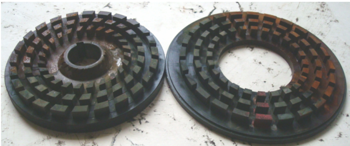
Рисунок 3.15 – Фото робочих органів з 24 каналами
