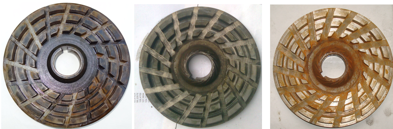
Рисунок 3.20 – Фото робочих колес зі змінною шириною каналу
