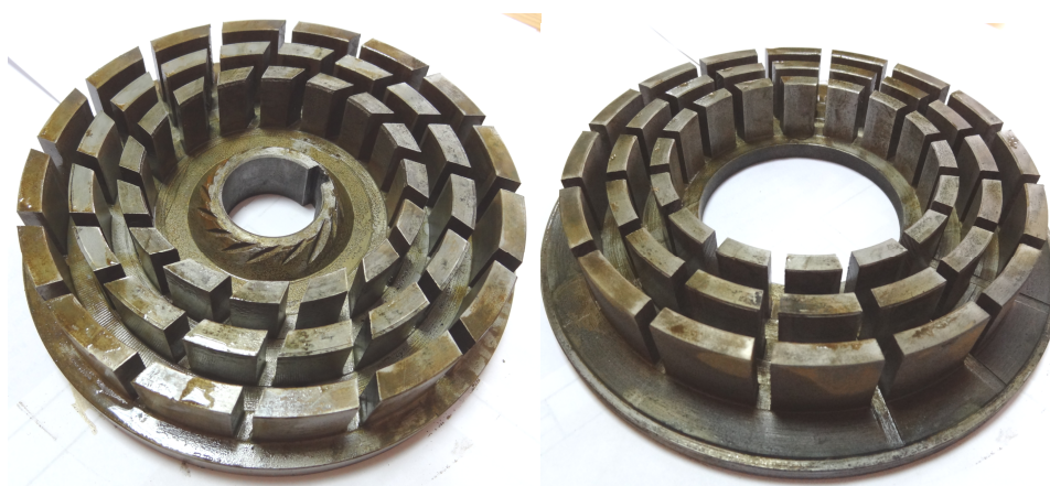
Рисунок 3.23 – Фото проточної частини зі збільшеною шириною ступеня
