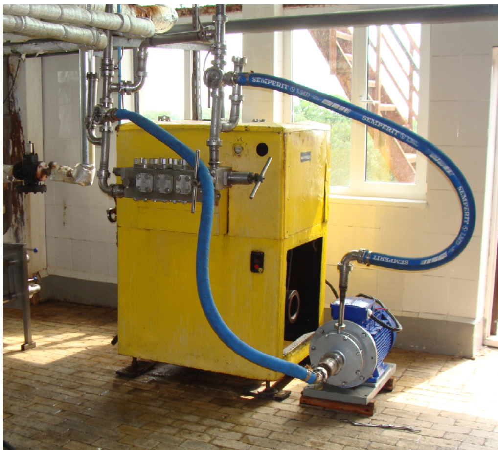
Рисунок 4.11 – Багатофункціональний ГАГ та плунжерний гомогенізатор в умовах ТОВ "Добряна", м. Суми
