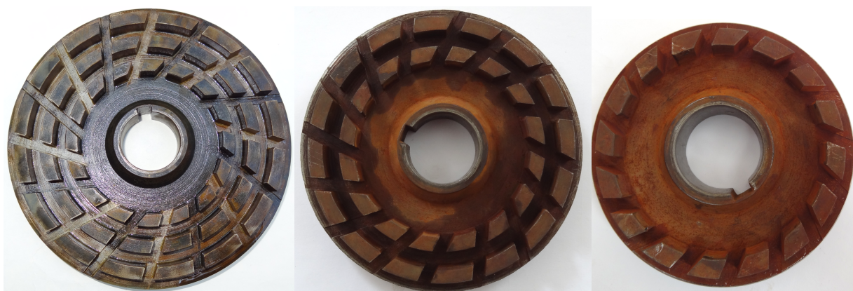
Рисунок 3.29 – Фото робочих колес ГАГ до та після підрізки ступенів
