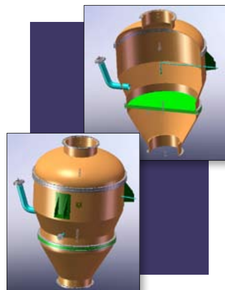
Студенческий проект: гранулятор-сушилка для линии производства гранулированных минеральных удобрений (9 сборочных узлов, 28 деталей, программа для технологического расчета процесса производства минеральных удобрений)
