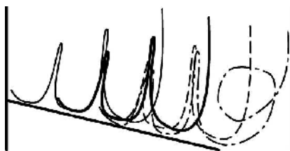
Рисунок 16 – Робота сушарки у режимі унесення зернистого матеріалу
