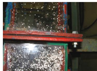
Рисунок 16 – Робота сушарки у режимі унесення зернистого матеріалу
