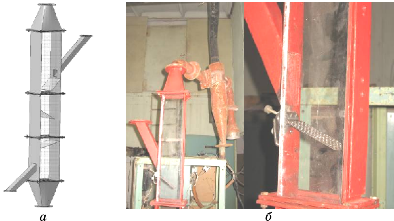
Рисунок 4 – Експериментальний зразок гравітаційної полицної сушарки: а - модель; б - фото
