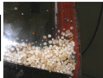
Рисунок 13 – Робота сушарки у режимі зваженого шару зернистого матеріалу
