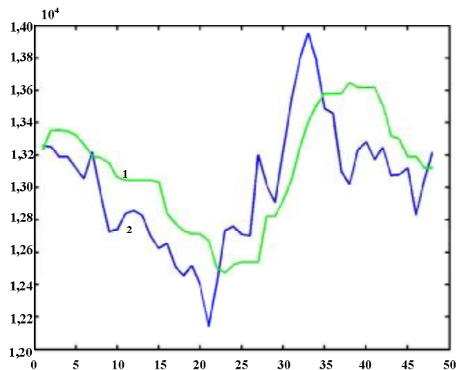
Рисунок 4- Графики зависимостей реального и прогнозного значений активной получасовой нагрузки ОАО «Сумыхимпром» при прогнозировании с помощью ИНС размерностью 8:5:1 (1-прогнозируемое значение, 2-реальное значение)
