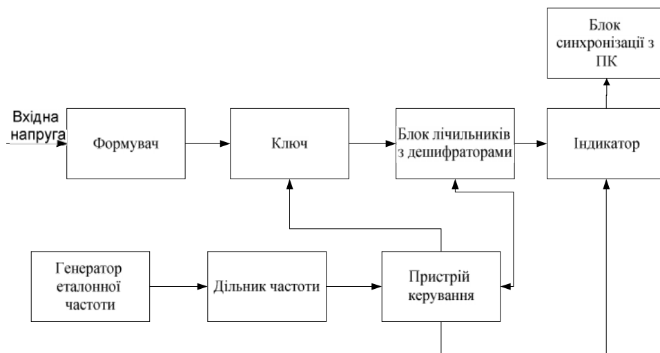
Рисунок 1 – Структурна схема частотоміра на основі біноміального лічильника
