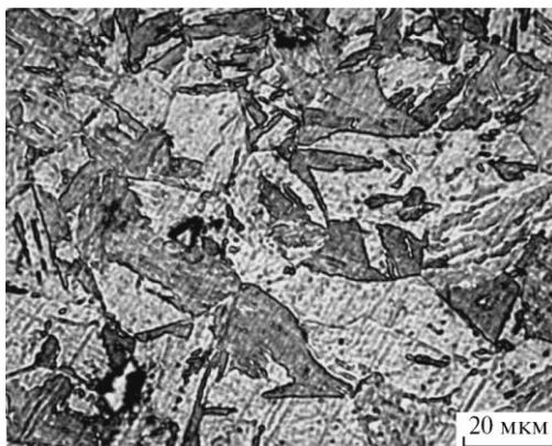
Рисунок 3.1 – Зеренна структура сталі ЕИ-832 після термічної обробки (гартування – нагрів до 900 °С, витримка 1 год, охолодження у воді, старіння 520 °С – 3 год); \times 600
