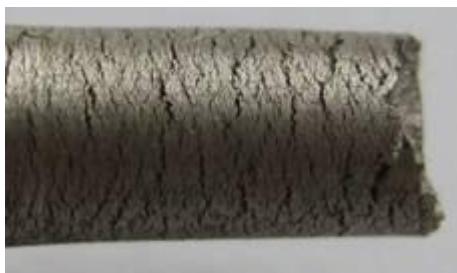
Рисунок 2.5 – Міжкристалітне корозійне руйнування аустенітної сталі 02Х20Н25Б після 700 год випробування у воді, що містить 100 мг/л Cl (домішка FeCl_3 ), при 300 °С і 9 МПа. х200
