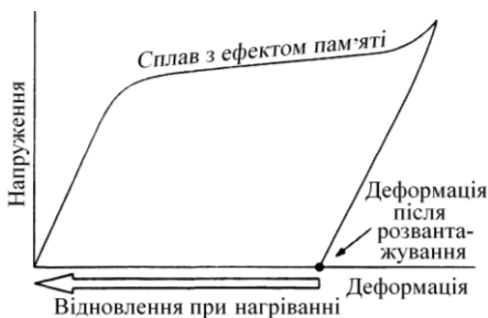
Рисунок 4.9 – Діаграма деформації «напруження-деформація», що демонструє макроскопічну поведінку металів з односторонньою пам'яттю форми
