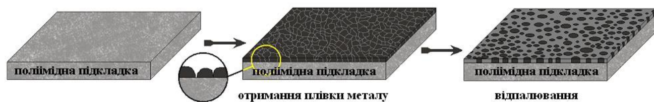
Рис. 2.4. Схематичне зображення процесу виготовлення масиву наночастинок металу на полімерній підкладці
