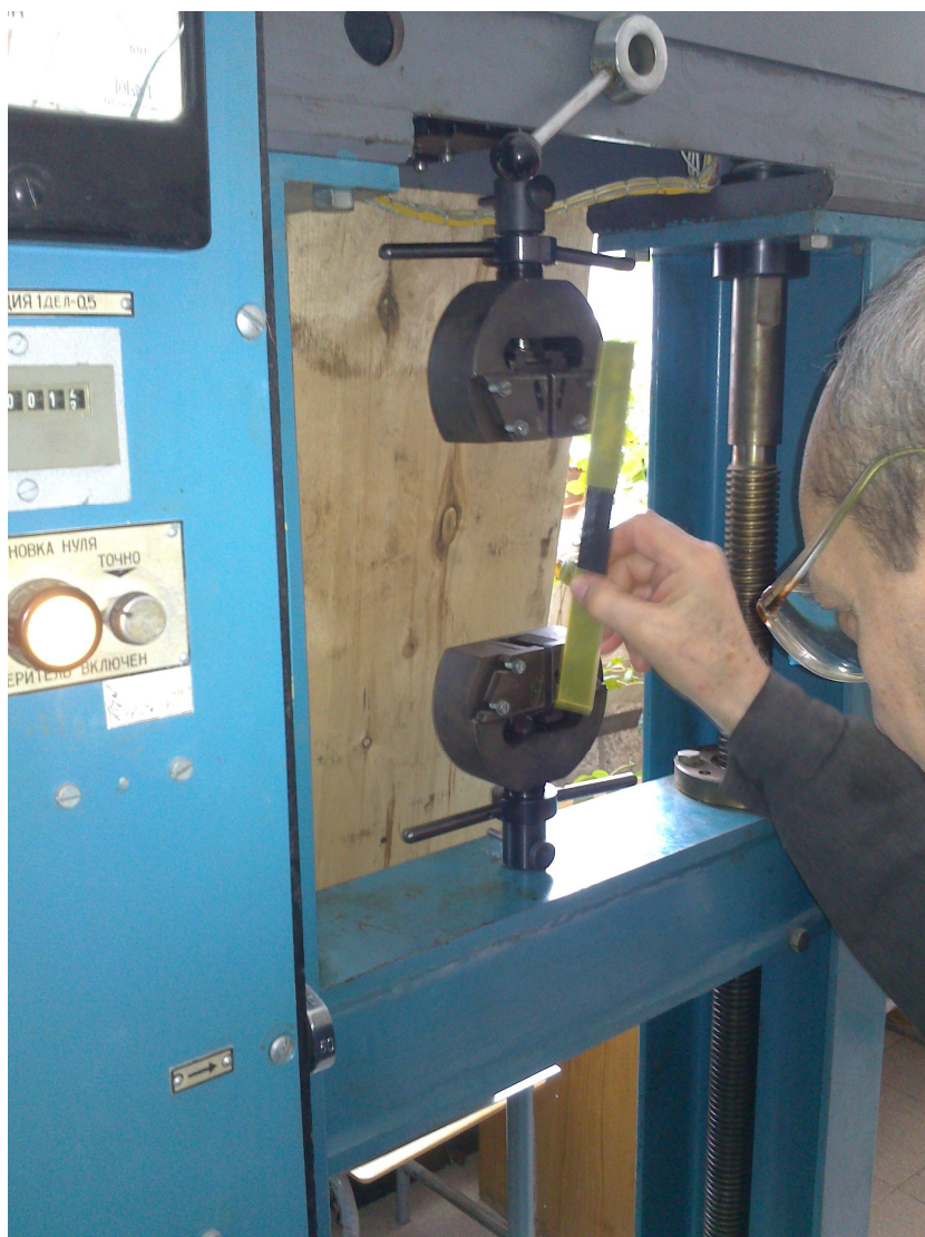
Рисунок 2.22 – Испытание образца из углепластика на растяжение
