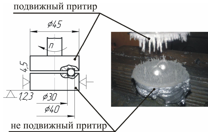
Рисунок 2.12 – Притирка твердосплавного индентора
