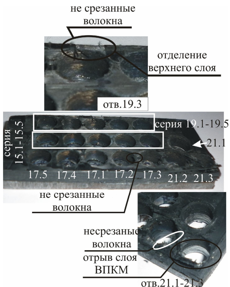
Рисунок 5.20 – Характерные дефекты отверстий после сверления
