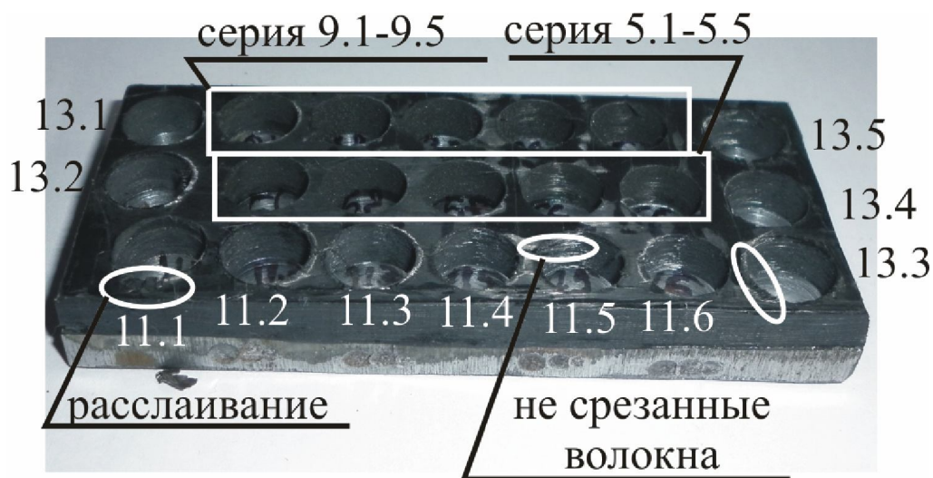
Рисунок 5.19 – Характерные повреждения отверстий пакета ВПКМ/Металл на различных этапах обработки
