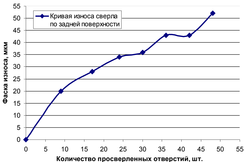
Рисунок 5.16 – Тенденция развития фаски износа при обработке пакета ВПКМ/Металл
