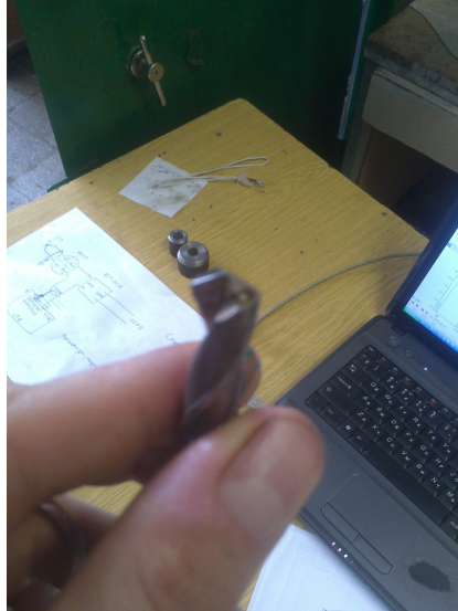
Рисунок 2.16 – Сверло в сборе с термопарой
