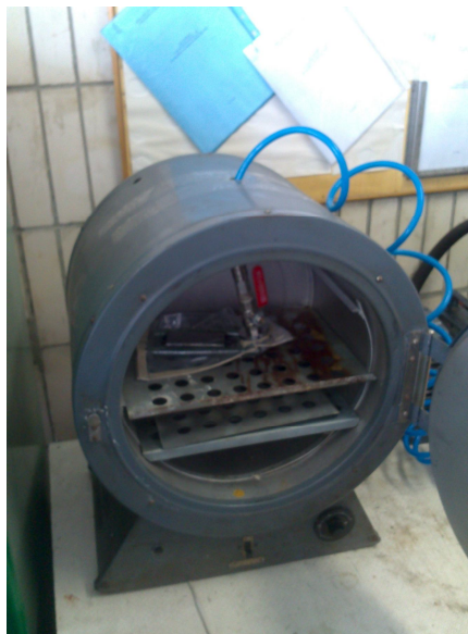
Рисунок 2.8 – Печь с подведенным вакуумом
