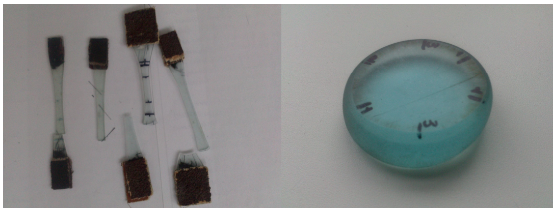
Рисунок 2.21 – Образцы из эпоксидной смолы после испытаний на растяжение
