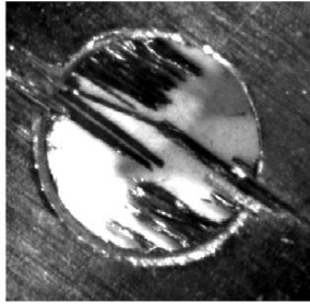
Рисунок 1.12 – Пример расслаивания наружных слоев листа ВПКМ у поверхности врезания сверла Рисунок 1.13 – Пример расслаивания наружных слоев ВПКМ у поверхности выхода сверла
