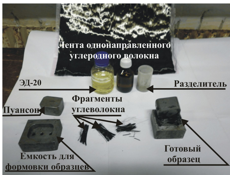
Рисунок 2.4 – Компоненты для изготовления образцов
