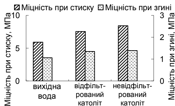
Рисунок 11 – Міцність гіпсового каменю, замішаного на ЕХА водопровідній воді
