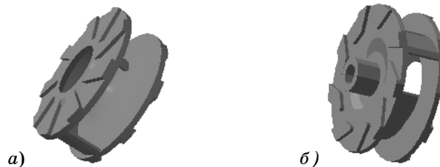
Рисунок 2 - Робочі колеса відцентрового насоса: а) однолопатеве; б) дволопатеве
