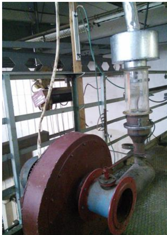
Рисунок 2.1 – Експериментальна установка для капсулювання добрив
