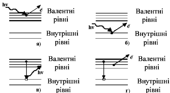
Рисунок 7.2 – Процеси, характерні для електронної спектроскопії: а – УФЕС; б – РФЕС; в – рентгенівська флуоресценція; г – оже-процес
