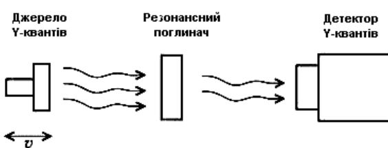
Рисунок 7.33 – Спрощена схема мессбауерівського спектрометра
