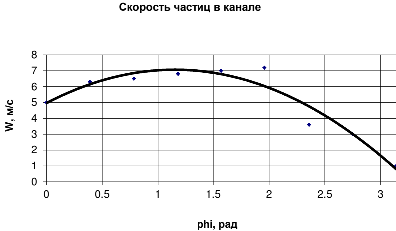
Рисунок 3.22 – График изменения абсолютной скорости капли по результатам компьютерного моделирования при r=0,14 м
