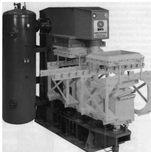
Рисунок 4.6 – Загальний вигляд формувальної машини типу HSP моделі 4841 фірми HEINRICH WAGNER SINTO MASCHINENFABRIK GMBH (Німеччина)
