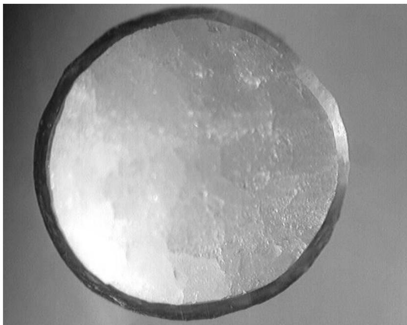
Рисунок 5.1 – Снимок разреза гранулы нитрата аммония с НЦ покрытием, полученный под микроскопом со степенью увеличения  $63,3^x$
