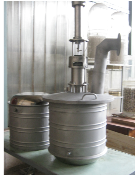
Рисунок 5.2 – Модифікований обертовий вібраційний гранулятор: а) схема; б) фотографія.
