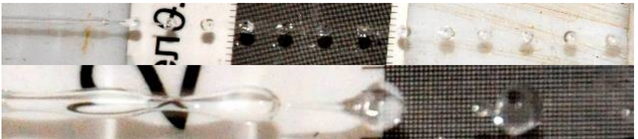
Рисунок 3.6 – Режим розпаду струменя при вимушених збуреннях з рівнем рідини в корпусі гранулятора 380 мм і амплітудою 4,4 В при частоті сигналу 380 Гц
