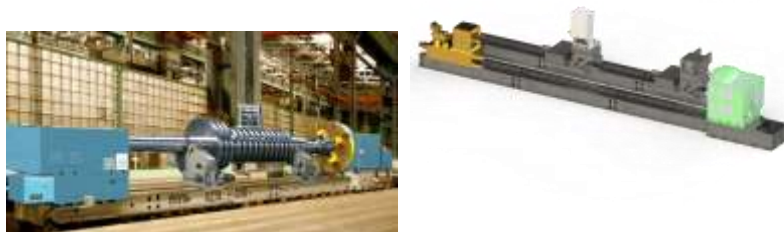
Рисунок 1 – Тяжелый токарный станок мод.1К675Ф3 с наибольшим диаметром обработки 2550мм и длиной 12500 мм
